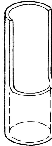
Figure 18. Cut-Away Tubular Terminal
